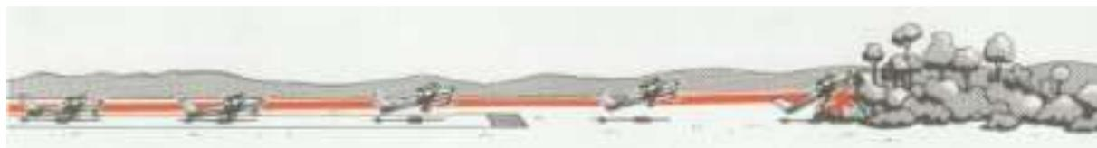
Die steile Lage des Luftfahrzeuges erweckte den Eindruck einer hohen Steiggeschwindigkeit, bis der Flug ein jähes Ende nahm. Weniger Höhensteuer und damit ein kleinerer Anstellwinkel hätten einen größeren Steigwinkel und die nötige Hindernisfreiheit gebracht (siehe z. B. den Betriebspunkt mit  $9^\circ$  Anstellwinkel).
